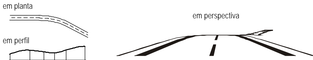
FIGURA 3.17 – DEFEITOS EM TRAÇADOS : MERGULHO RASO
