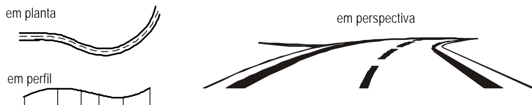
FIGURA 3.19 – DEFEITOS EM TRAÇADOS : SALTO
