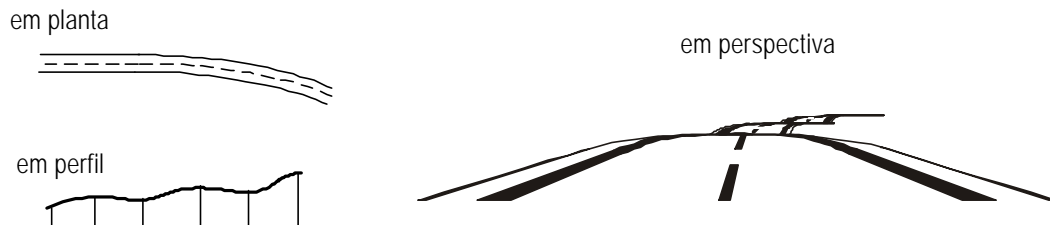
FIGURA 3.18 – DEFEITOS EM TRAÇADOS : MERGULHO PROFUNDO
