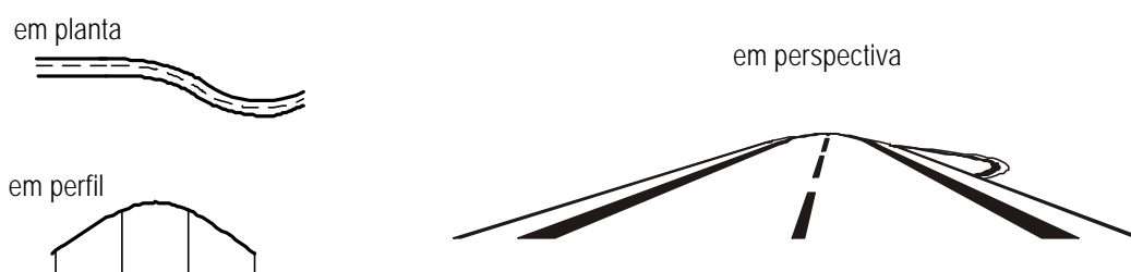
FIGURA 3.21 – DEFEITOS EM TRAÇADOS : INÍCIO DA CURVA HORIZONTAL NA ÁREA CONVEXA
