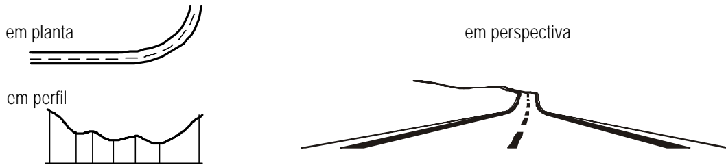
FIGURA 3.16 – DEFEITOS EM TRAÇADOS : ONDULAÇÕES NA CURVA
