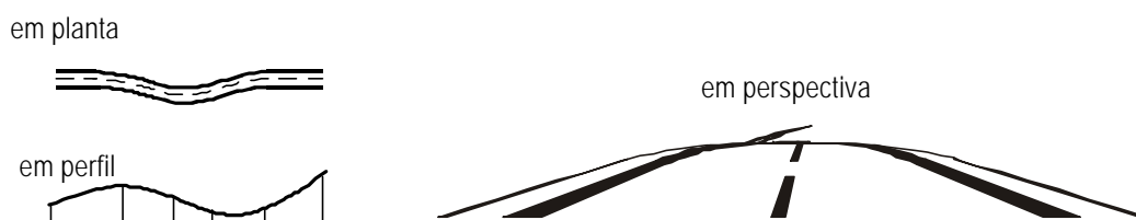
FIGURA 3.20 – DEFEITOS EM TRAÇADOS : SALTO COM DEFLEXÃO
