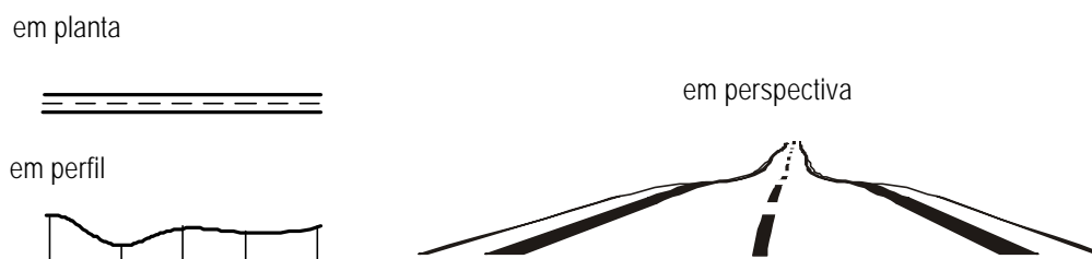
FIGURA 3.15 – DEFEITOS EM TRAÇADOS : ABAULAMENTOS (TOBOGÃ)
