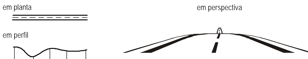
FIGURA 3.13 – DEFEITOS EM TRAÇADOS : MERGULHO EM TANGENTE
